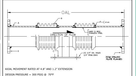
AXIAL 3D Model DIA FORCE TO WEIGHT QTY ID # OR TAG # **KEFLEX PART #** OAL COMPRESS (IN) (LBS) (.stp) (LBS) 8″ F080H308DB3006 30″ 750 158 3D 10" F100H308DB3006 30″ 1000 201 3D
